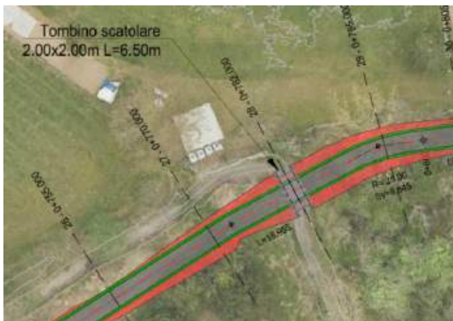
Figura 32 – Stralcio planimetrico dello scatolare prefabbricato 2x2.
