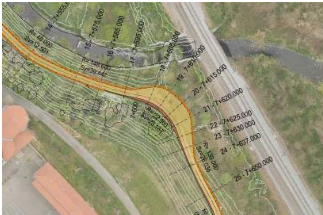
Figura 17 - Piazzola di sosta
